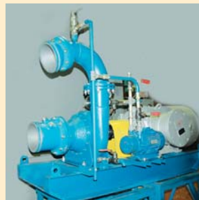
Насосная установка УОДН-В 300-200-150 в комплекте с вакуумным насосом
